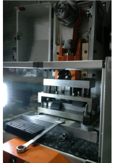
FOTO DI ESEMPIO: SI ESEGUONO OPERAZIONI DI TRANCIATURA SU PROFILI ESTRUSI IN ALLUMINIO
